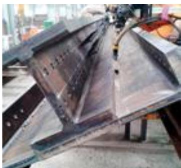
大型埋地柱制造
